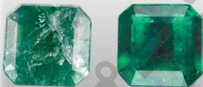
含浸処理前 含浸処理後
